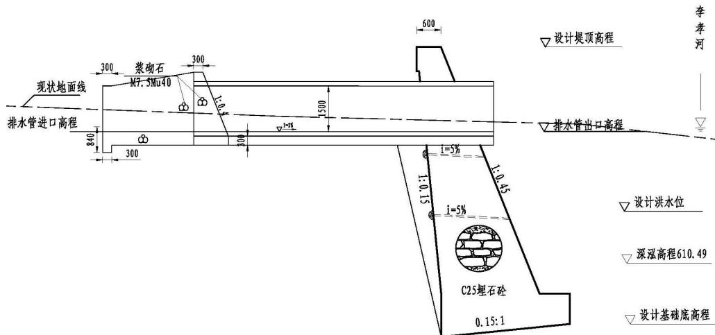
图 2-3 排水涵管典型断面设计图
