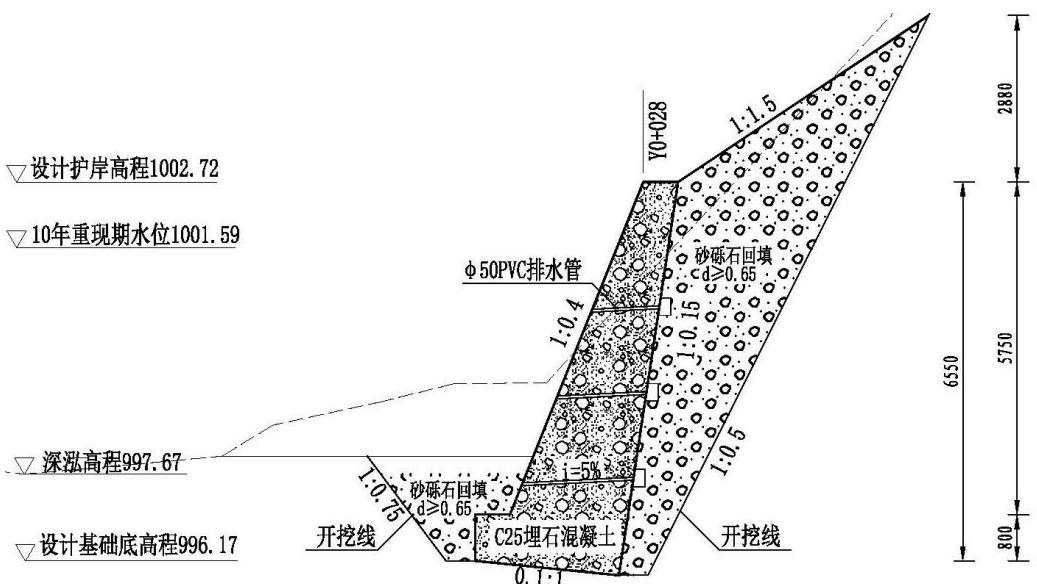
图 2-1 仰斜式挡土墙典型断面图
