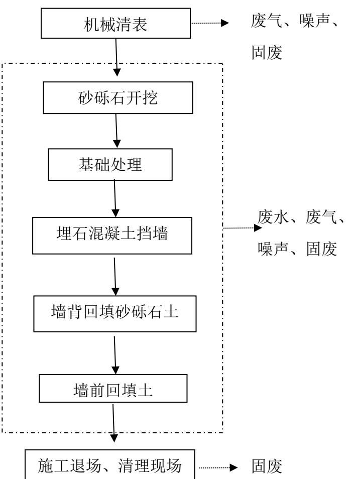
图 2-4 施工期工艺流程及产污环节图
